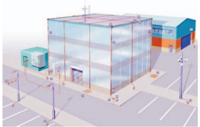
Şekil 5. Yıldırımdan korunma sistemi döşenmiş bir tesis. Yıldırım çubukları ve topraklama hatları görülmektedir.
