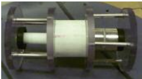
Şekil 9. [21] Mıknatıs, bobin ve gövdenin bitmiş hali
