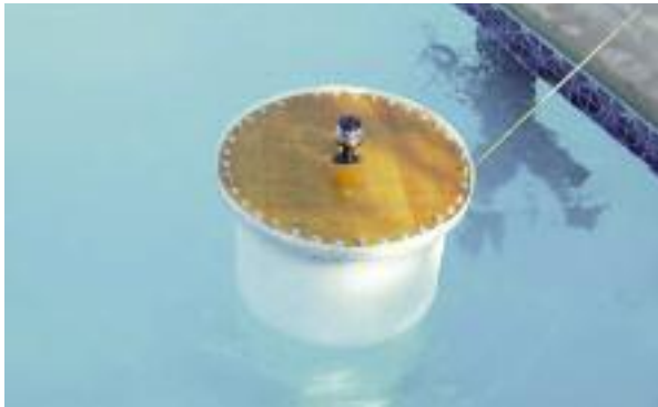
Şekil 16. Sistemin havuzda batmazlık testi
