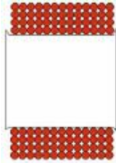
Şekil 15. Kesiti gösterilen, bobin üzerinde çok sıralı ve çok katmanlı sargı (orantılı çizilmemiştir)
