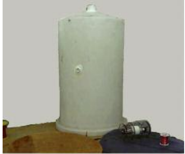
Şekil 10. [21] Üçüncü tasarımda kullanılan parça ve malzemeler. Parça ve malzemeler delikleri kapanarak su sızdırmazlığı sağlanmış bir bidon (ortada/üstte), mıknatıs-bobin birleşimi (bidonun sağında), bobin teli (sağ altta) ve üst tahta kapak (sol altta)'tan ibarettir.
