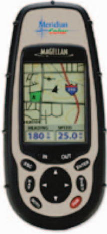
Şekil 1. Tipik bir GPS alıcısı (Magellan Inc.)
