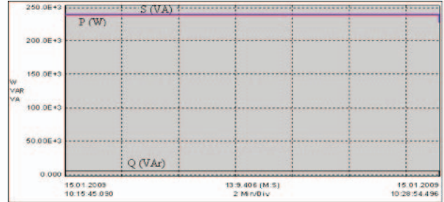
Şekil 8. Kompanzasyon yapıldıktan sonra yapılan güç analiz ölçümleri.
